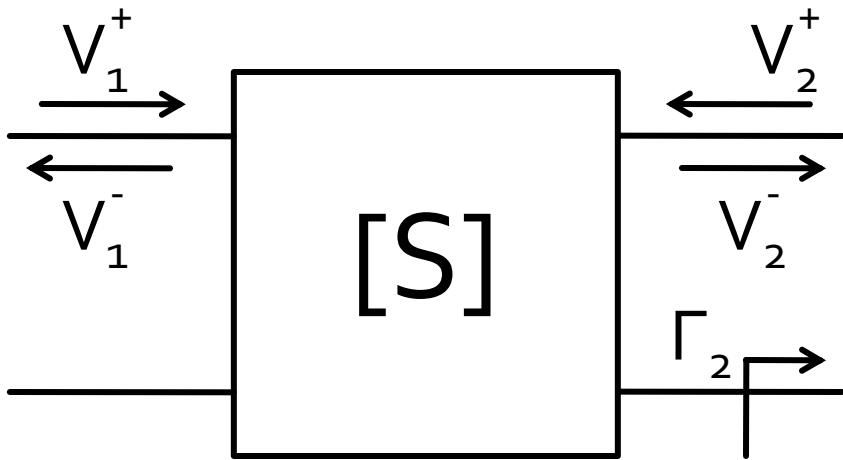
$$\begin{bmatrix} V_1^- \\ V_2^- \end{bmatrix} = \begin{bmatrix} S_{11} & S_{12} \\ S_{21} & S_{22} \end{bmatrix} \cdot \begin{bmatrix} V_1^+ \\ V_2^+ \end{bmatrix}$$
