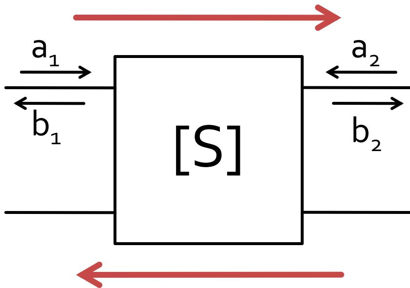
$$\begin{bmatrix} b_1 \\ b_2 \end{bmatrix} = \begin{bmatrix} S_{11} & S_{12} \\ S_{21} & S_{22} \end{bmatrix} \cdot \begin{bmatrix} a_1 \\ a_2 \end{bmatrix}$$
